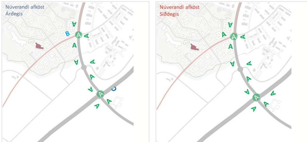
MYND 2.8 Núverandi þjónustustig við Baugshlíð og Vesturlandsveg. Niðurstöður sýna þjónustustig götuleggja og gatnamóta.
